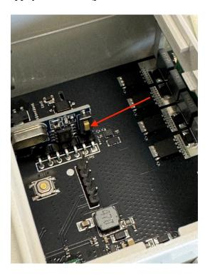
La LED de signalisation sur le récepteur (voir flèche) s'allume. Le récepteur est alors en mode d'apprentissage. Appuyez et maintenez enfoncé n'importe quel bouton sur la télécommande pendant au moins 3 secondes. La LED de signalisation sur le récepteur s'éteint.
